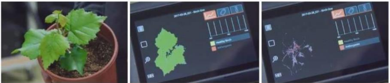
左：通常写真／中央：健康生育部分／右：ストレスで紅色化した部分の観察ができる
