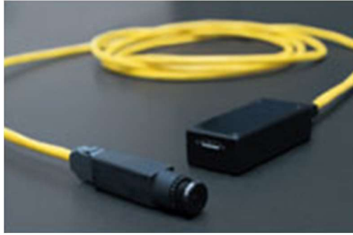
図2. 小型分離ヘッドグローバルシャッターカメラ
