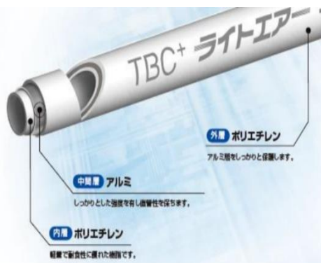
三層管配管システム
